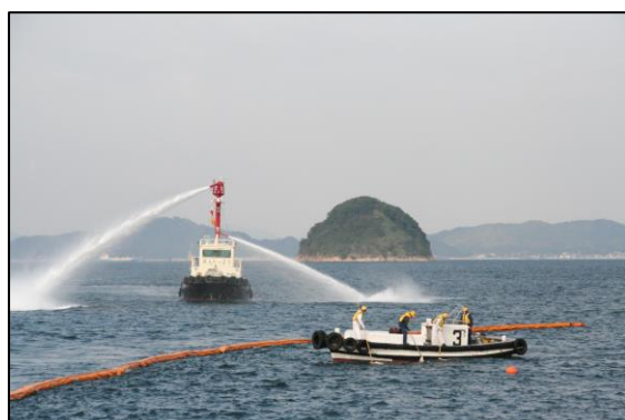
オイルフェンスの展張および 浮遊油の拡散
